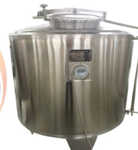
Cuve de fermentation – Contrôle automatique de la température et agitation pour la production industrielle de yaourt
